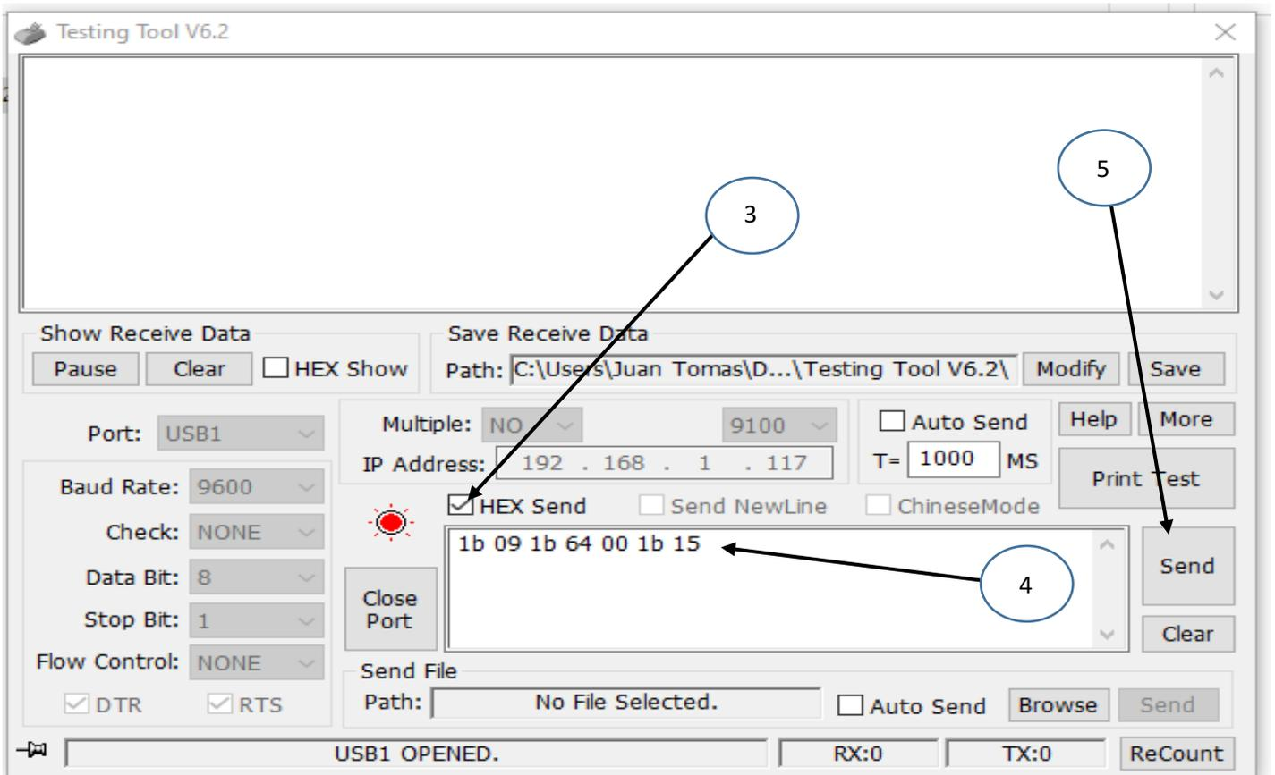
2.- Luego ejecutamos el utilitario general para cambio de parámetros de las impresoras series 2C-POS80-02, el utilitario, "Testing Tool V6.2.exe"
